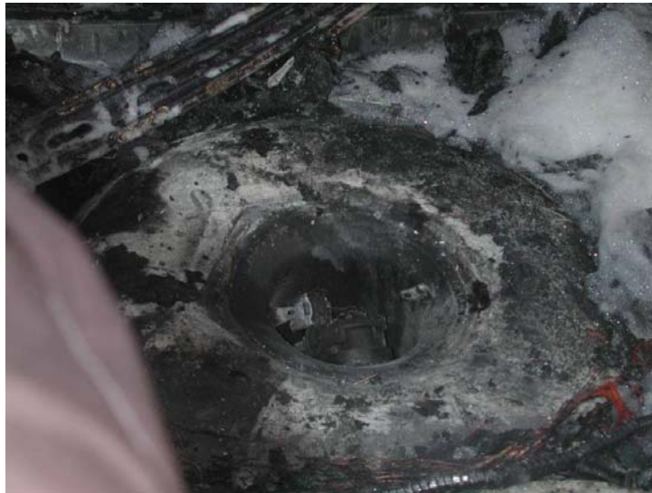
Figura 10: depósito de Autogas intacto después de la prueba de incendio.
